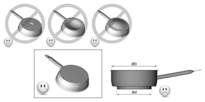
如果鍋具底部的直徑(Ød)明顯小於鍋具本身的(ØD)直徑,比較不符合感應電磁爐,這樣熱效率比較不好。
